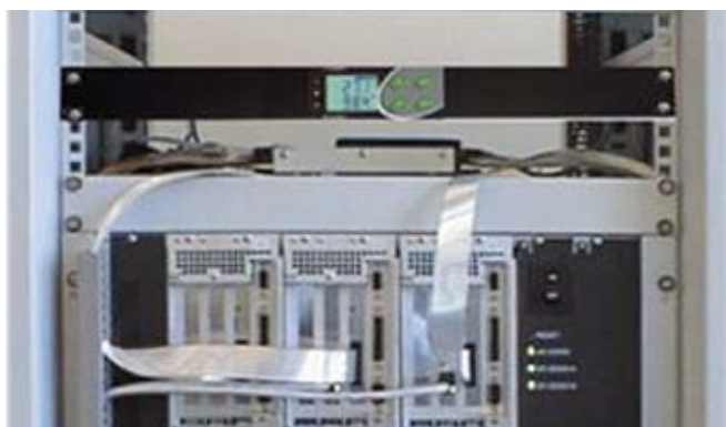
Van de SensoStat zijn een drietal modellen speciaal geschikt voor inbouw in een 19" rack.
